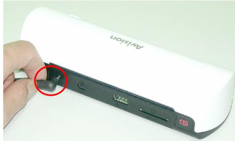
2. Conecte o adaptador de alimentação a uma tomada da rede elétrica. Espere até que a luz indicadora no escâner páre de piscar e permaneça estável, indicando que o escâner está pronto.
