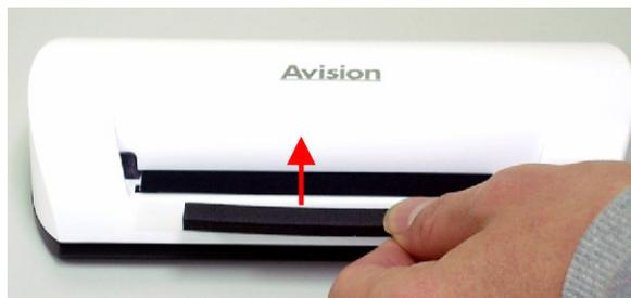
5. A ferramenta de limpeza será trazida ao slot de alimentação automaticamente, e o processo de limpeza se iniciará.
