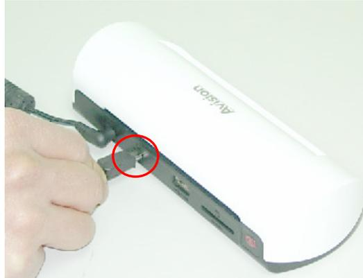
5. Ligue o seu PC, e em seguida conecte a extremidade maior do cabo USB a uma porta USB no seu PC.
